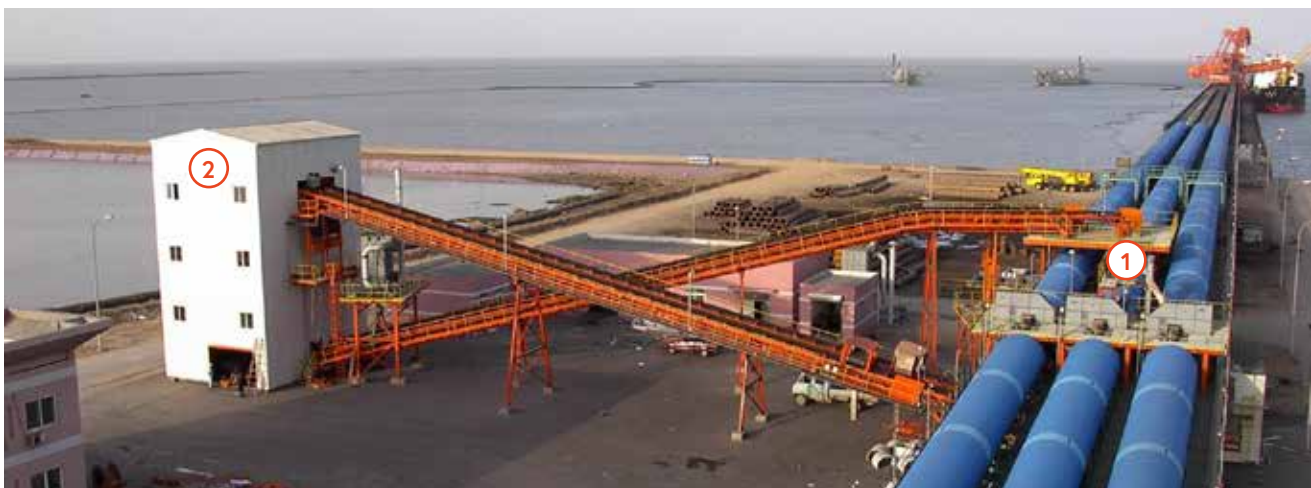
Toma de muestra (1) y preparación de muestra (2) de carbón durante la carga de un navío
