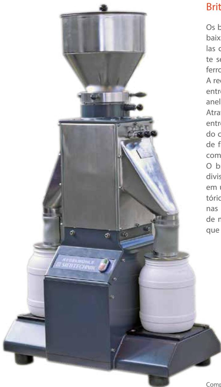
Britador cônico KM 65 com dispositivo divisor
